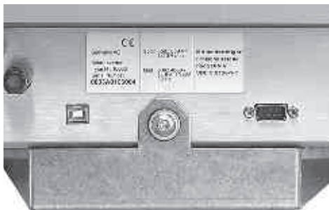
Abb.: USB-Stecker (links) und SUB-D9-Stecker (rechts) auf der Geräteunterseite.
