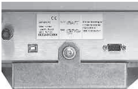
Fig.: Conector USB (izquierda) y SUB-D9 (derecha) para el puerto RS232, en la parte inferior del aparato
